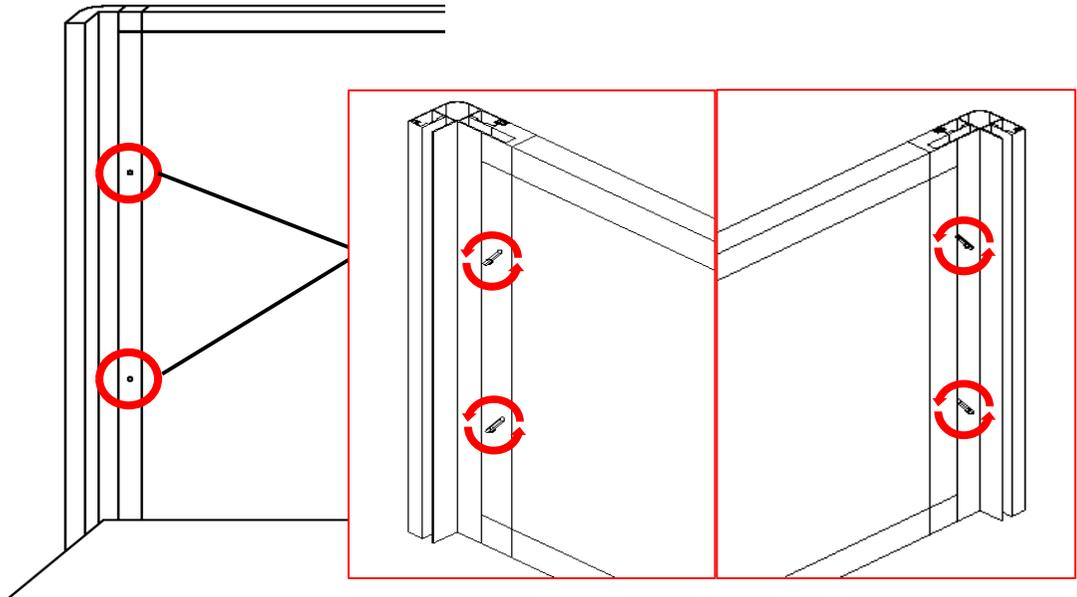
上下の方向に気をつけて、パネルと柱をしっかりと付けて六角レンチで反時計周りに回して固定する。
