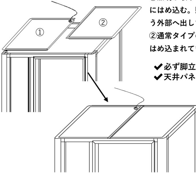
①照明が取り付けられている天井パネルを先にはめ込む。照明コードは隙間に挟まないよう外部へ出しておく。
